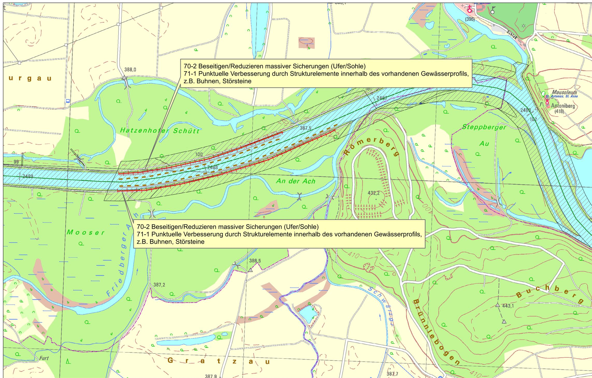
70-2 Beseitigen/Reduzieren massiver Sicherungen (Ufer/Sohle)
