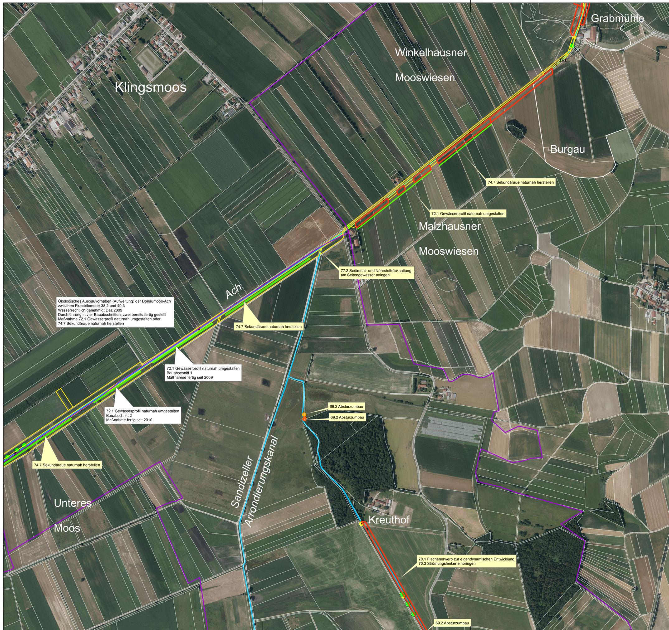
Ökologisches Ausbauprojekt (Aufweitung) der Donaumoos-Ach zwischen Flusskilometer 38,2 und 40,3. Wasserrechtlich genehmigt Dez 2009. Durchführung in vier Bauabschnitten, zwei bereits fertig gestellt. Maßnahme 72.1 Gewässerprofil naturnah umgestalten oder 74.7 Sekundäraue naturnah herstellen.
