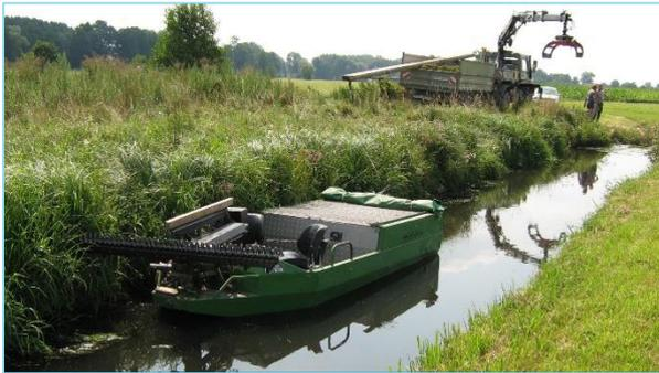
Bild 3: Mähboot im Einsatz an der Schutter
